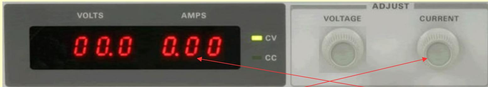
E' possibile trasformare l'alimentatore di tensione costante in un alimentatore di corrente costante regolando la manopola "current" ad un valore inferiore a quello corrispondente alla tensione applicata (in tali condizioni si spegne la spia CV e si accende quella CC)
