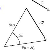
con  $\overline{\omega}$  vettore (che caratterizza la rotazione di  $\overline{v}$ ) di modulo  $\omega = d\phi/dt$ , direzione perpendicolare al piano individuato da  $\overline{v}(t)$  e  $\overline{v}(t+dt)$  e verso tale da vedere come antioraria la rotazione di  $\overline{v}(t)$
