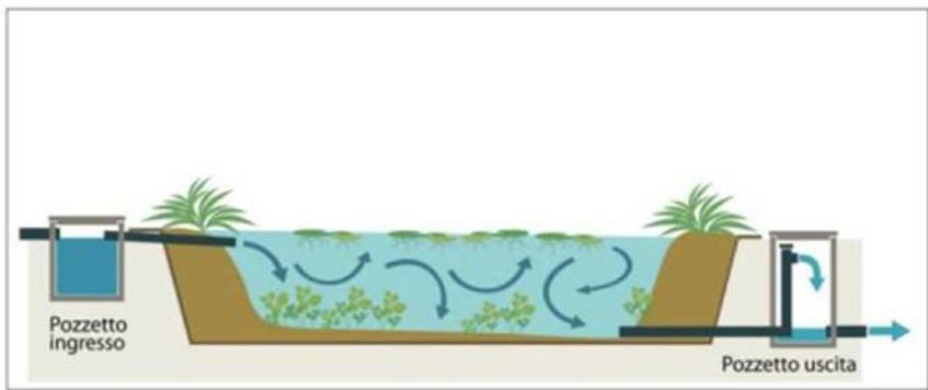
Figura 22. Sezione del funzionamento di un impianti di fitodepurazione a flusso libero.
