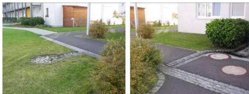
Figura 40. Tecniche di raccolta delle acque piovane; viene sfruttata la naturale permeabilità del suolo;
