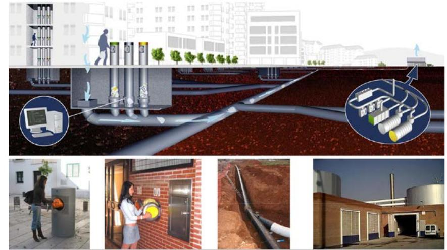
Figura 47. Il sistema pneumatico di raccolta rifiuti ENVAC
