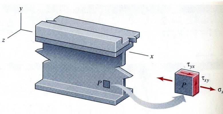
Gli stati tensionali piani sono molto frequenti negli impieghi ordinari di molti elementi strutturali quali ad esempio travi a spessore sottile, lastre, piastre, etc.
