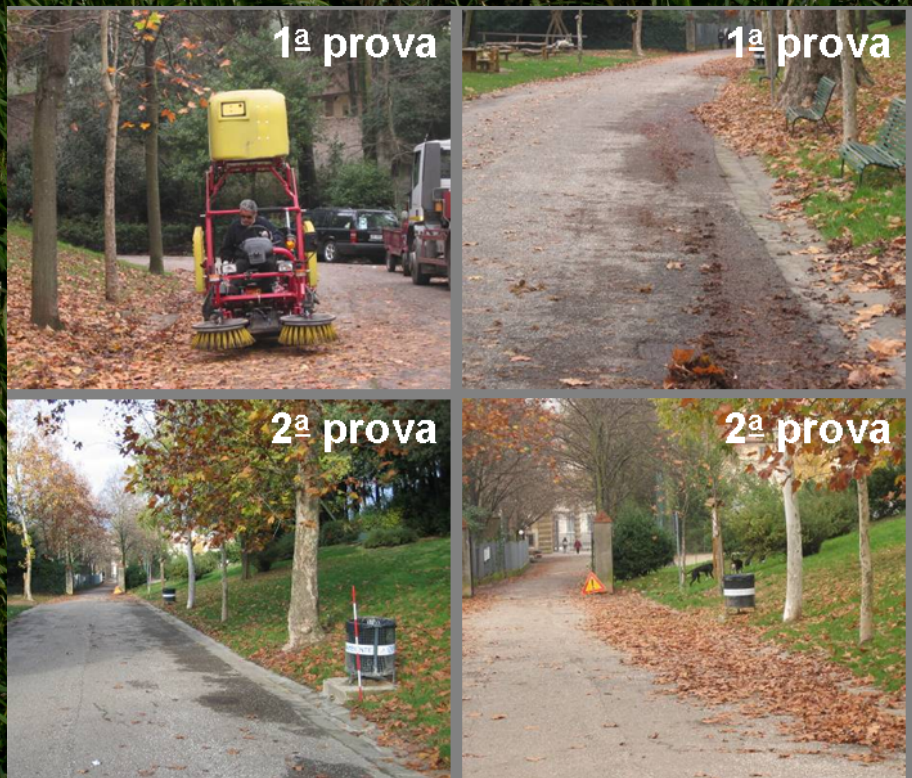
La superficie asfaltata oggetto della prova prima e dopo il passaggio con spazzatrice
