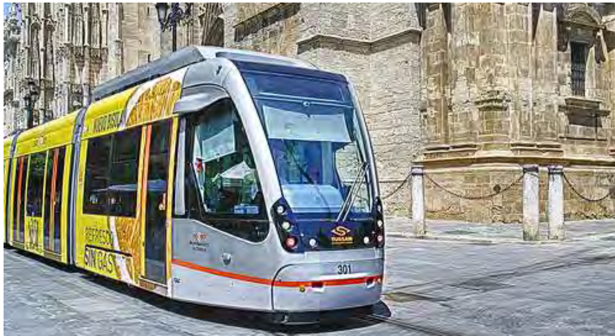
Tram senza fili con supercapacitore (Saviglia, 2011)
