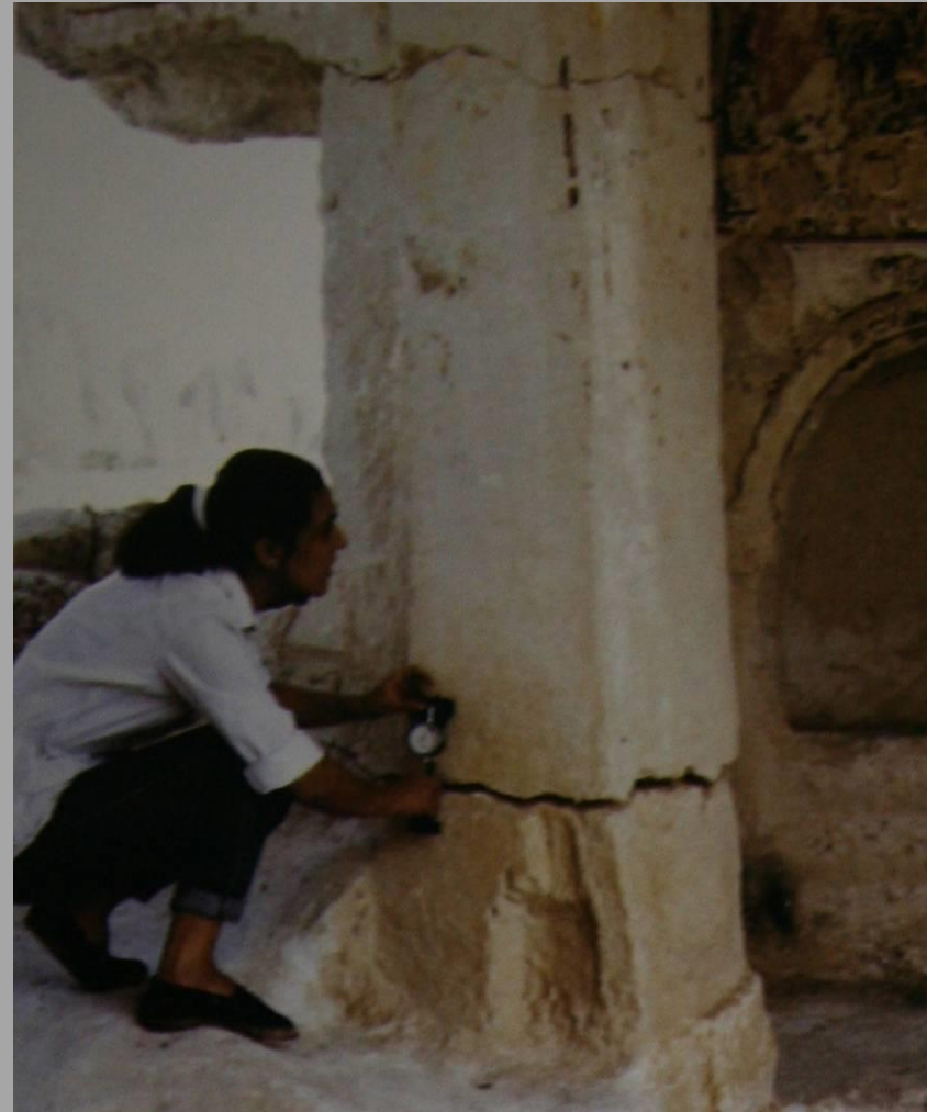
Controllo mediante estensimetro meccanico rimovibile (Cappadocia, Chiesa di El-Nazar, Goreme)
