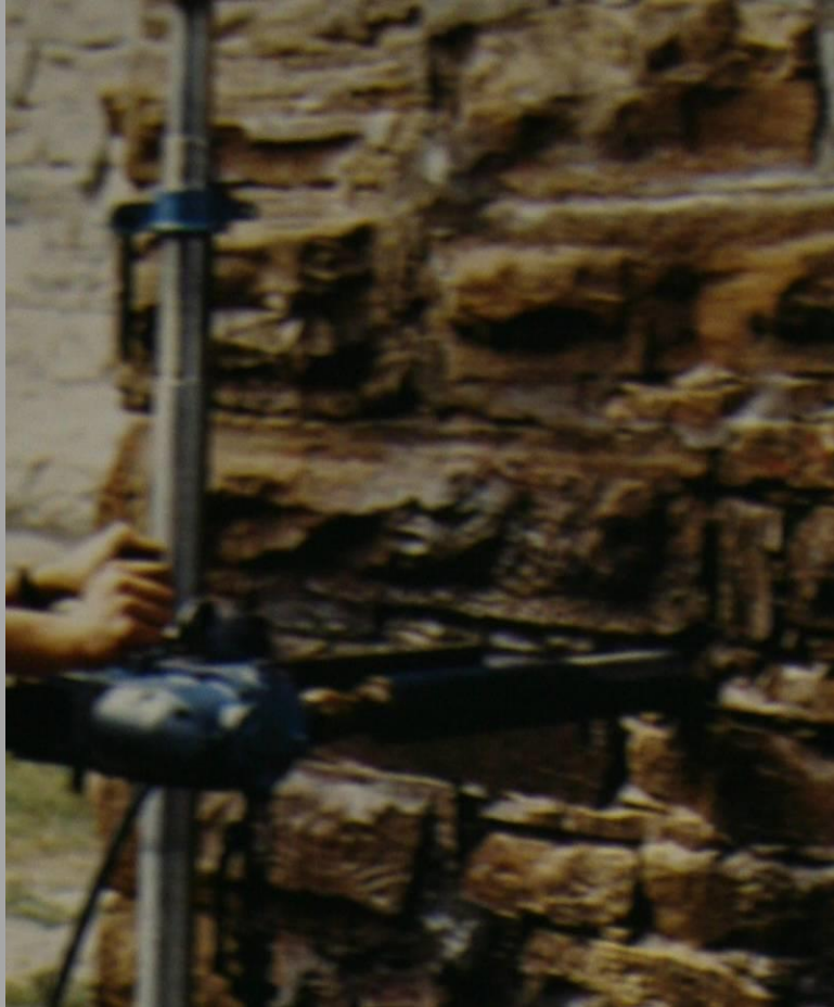
Carotatrice, prove di compressione monoassiale e determinazione della resistenza
