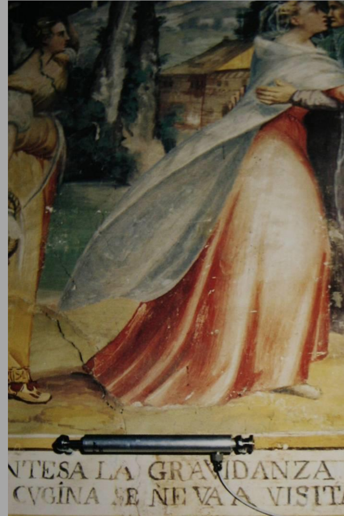
Fessurometro con trasduttore elettrico
