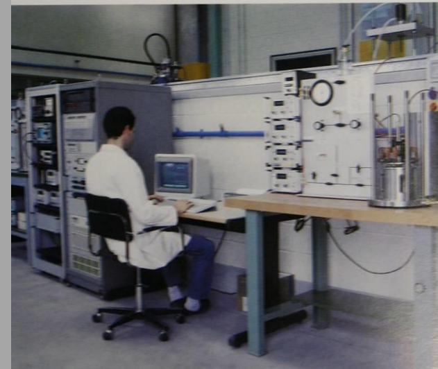
Attrezzature per prova triassiale ciclica e prova su colonna risonante (ISMES)
