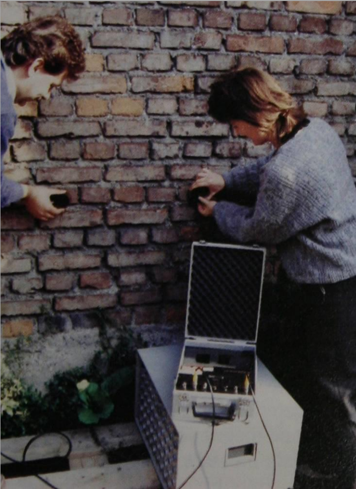
Misura della velocità di propagazione delle onde elastiche longitudinali (Conc. ISMES)
