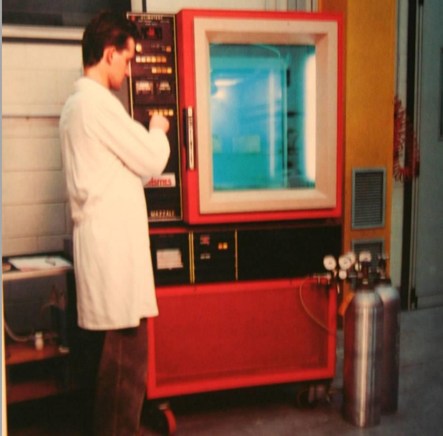
Camera automatica per l'esecuzione di cicli di invecchiamento accelerato (temperatura, umidità, agenti inquinanti, salificazioni) (ISMES)
