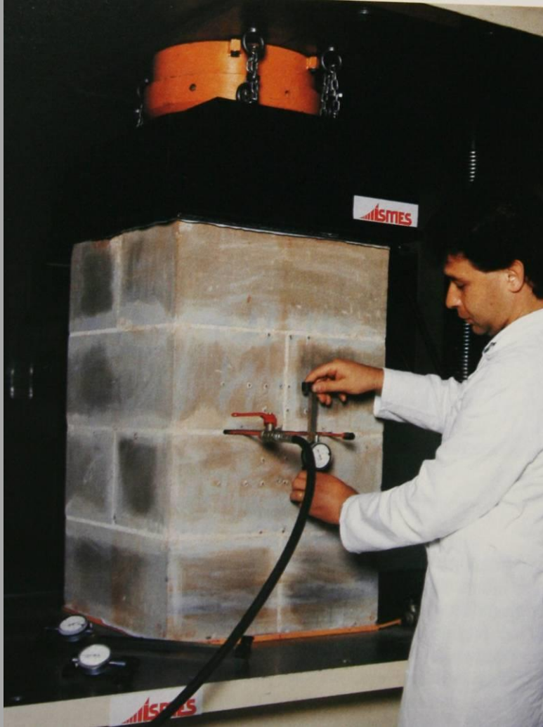
Taratura del martinetto su campione di muratura
