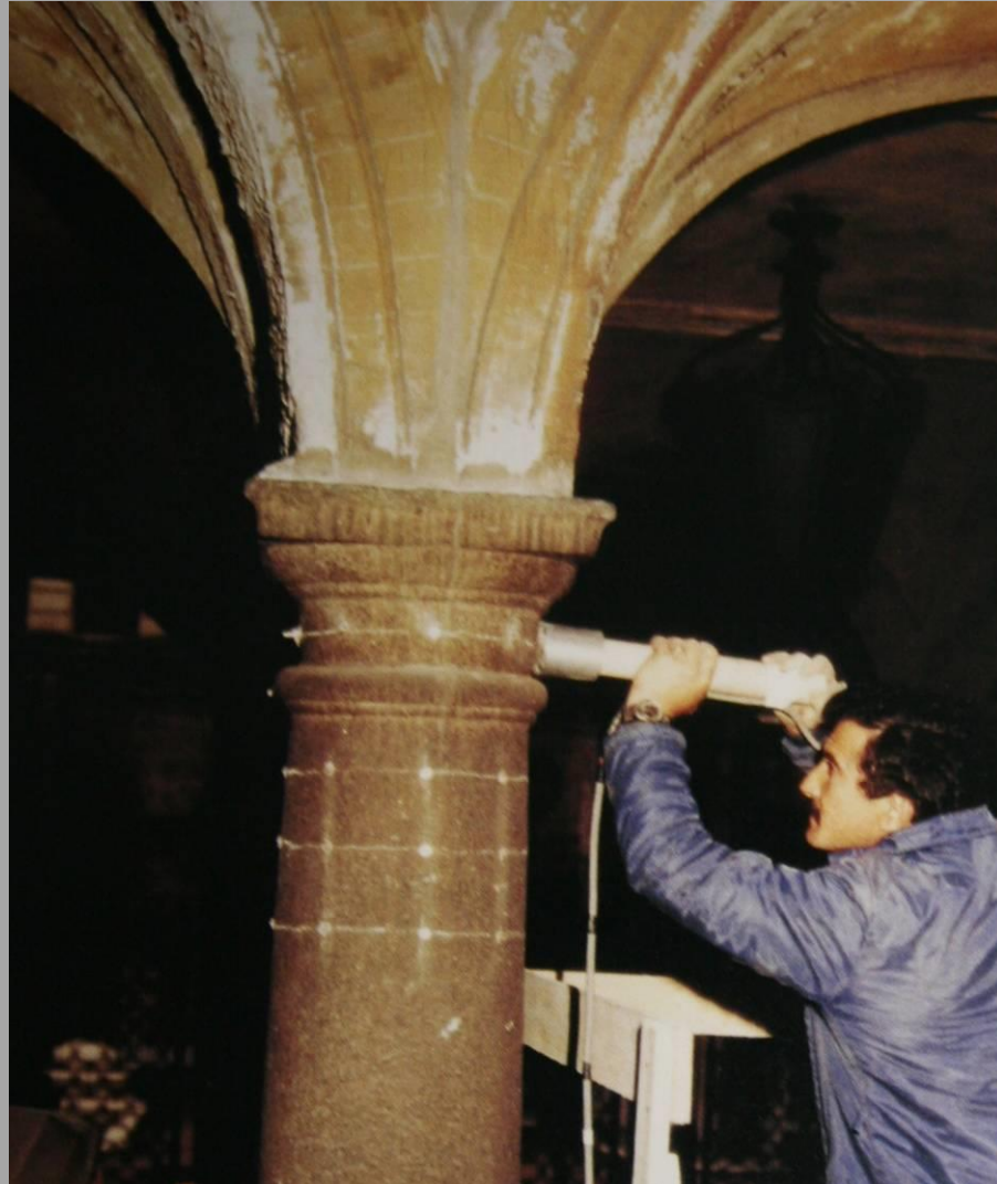
Misure di velocità sonica su colonne in pietra (ISMES)
