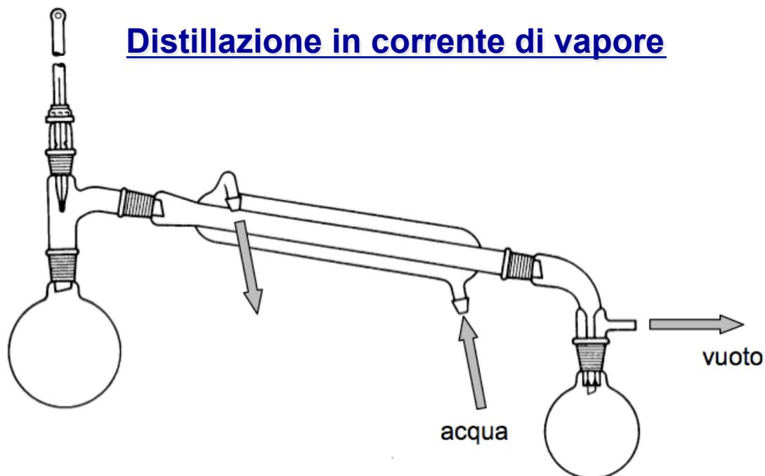
Apparecchio per distillazione in corrente di vapore, con opzione per operare a pressione ridotta.
