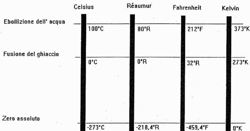
Figure 7.3: grafico delle scale termometriche
