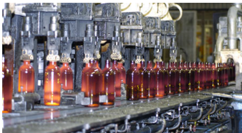
Le bottiglie ancora calde vengono poi fatte entrare in un forno di ricottura. Procedimento che serve per stabilizzare il vetro.
