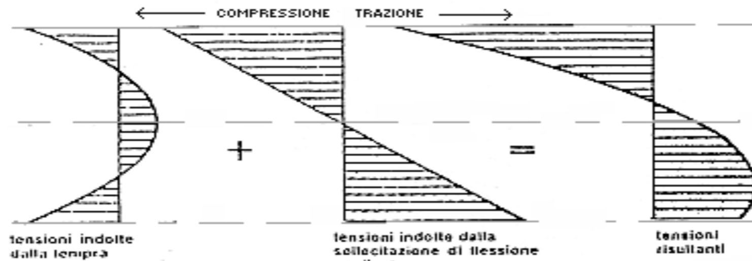
Tensioni in un vetro temprato sottoposto a flessione.
