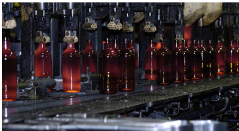
Una volta estratta, la bottiglia viene posizionata su un nastro trasportatore subendo un trattamento superficiale a caldo.
