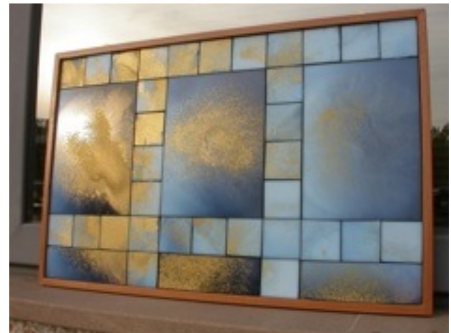
Vetroceramico nanostrutturato, il colore blu è causato dallo scattering di piccoli cristalli di alluminato di litio trasparenti.
