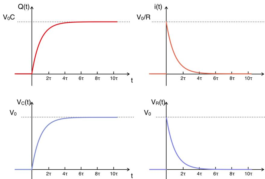
Se adesso consideriamo di partire al tempo  $t=t_0$  da un condensatore carico e di farlo scaricare, il che corrisponde a sostituire (dopo che il condensatore ha raggiunto la sua carica massima
