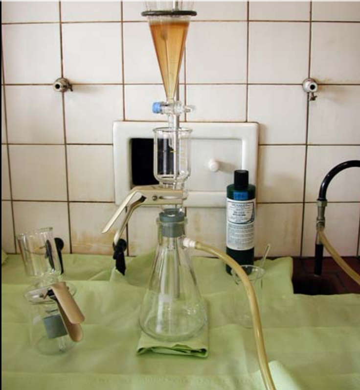
Separazione minerali con liquidi pesanti
